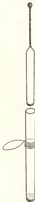
Abb. 20 b. Wägegläschen mit Glaspfropf und Alumi- niumgriff. (Na- tür. Größe.)
